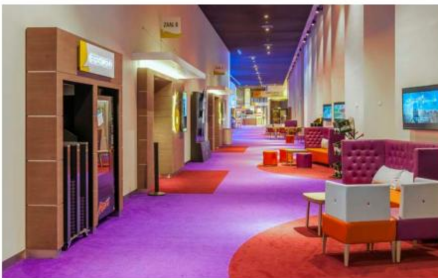
In de lange gang zijn metalen staanderplafonds gebruikt van de geperforeerde Knauff Cleaneo-plaat die het geluid zo veel mogelijk opneemt.
